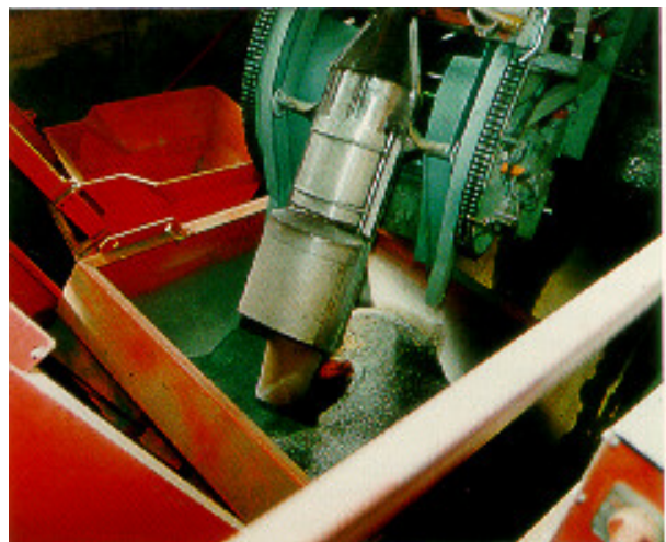
Bild 3: Bewegliches Wägegefäß, beim Entleeren in einen mit Zuschlägen halbgefüllten Förderkübel
